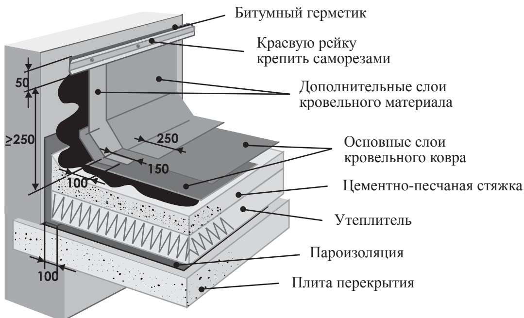
Рис. 22. Примыкание кровельной системы к вертикальной поверхности.
